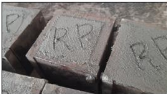
Fig.4.13 Cement mortar cubes
